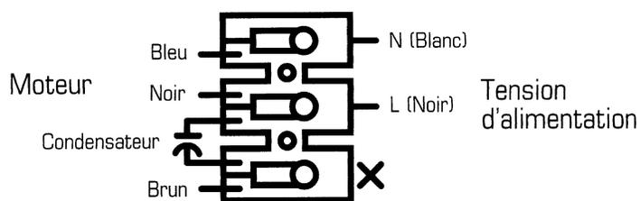
Il y a généralement trois fils à connecter à un ventilateur électrique, charge, neutre et mise à terre. La charge alimente le ventilateur, le neutre sert à rétablir le courant et à fermer le circuit électrique, et le fil de mise à terre à un chemin supplémentaire permettant de renvoyer le courant au sol en toute sécurité, en cas de court-circuit accidentel du ventilateur et / ou de décharge du ventilateur composants métalliques.
